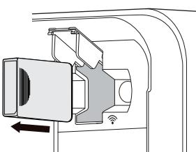
5. Lukk WLAN-adapterdekselet og luftinntaksgitteret.
