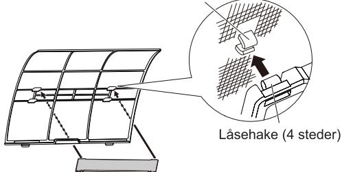
**MERKNADER:** Pass på at luftrensefilteret ikke stikker ut av rammen.
