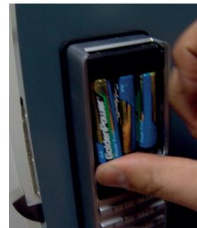
Forventet levetid er ca 6 - 12 mnd. Når låsen varsler med flere raske pipelyder ved åpning, bør man bytte batterier. Det anbefales og benytte batterier av god kvalitet ved batteribyte.
