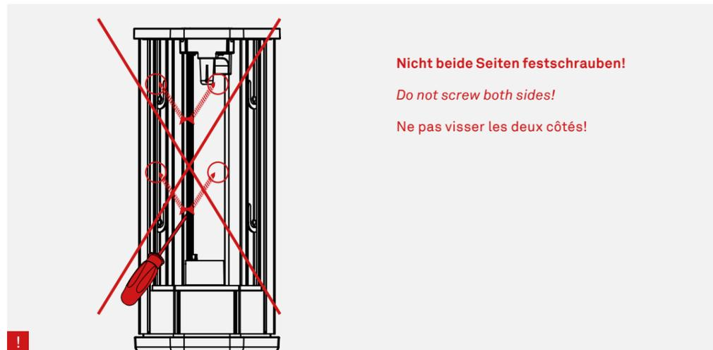
Montage der Edelstahlblende | Stainless steel cover mounting | Montage du couvercle en acier inoxydable
