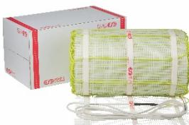
ØS Varmematte-80 er velegnet for tynne gulvkonstruksjoner, støpt i godkjente lavtbyggende støpemasser, eller direkte i fliselim. ØS Varmematte-80 kan installeres rett på brennbart underlag. Velegnet for nybygg, tilbygg og rehabilitering i tørre rom og i våtrom, med fliser som overgolv.
