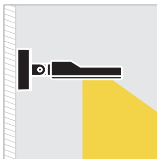
Asymmetrisk optikk kaster lyset langt ut fra veggen.
